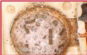
Ausfällungen im Auflösungsprozess durch PeKacid
